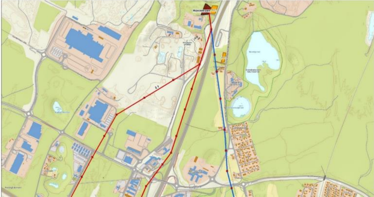
Figur 9. Oversiktskart over foreslått omlegging av høyspentledning. Blått strekk: eksisterende trasé. Røde strekk: To alternativer for ny trasé.
